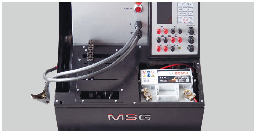
Рис. 18. MS004COM - Установленная аккумуляторная батарея с подключенными клеммами
